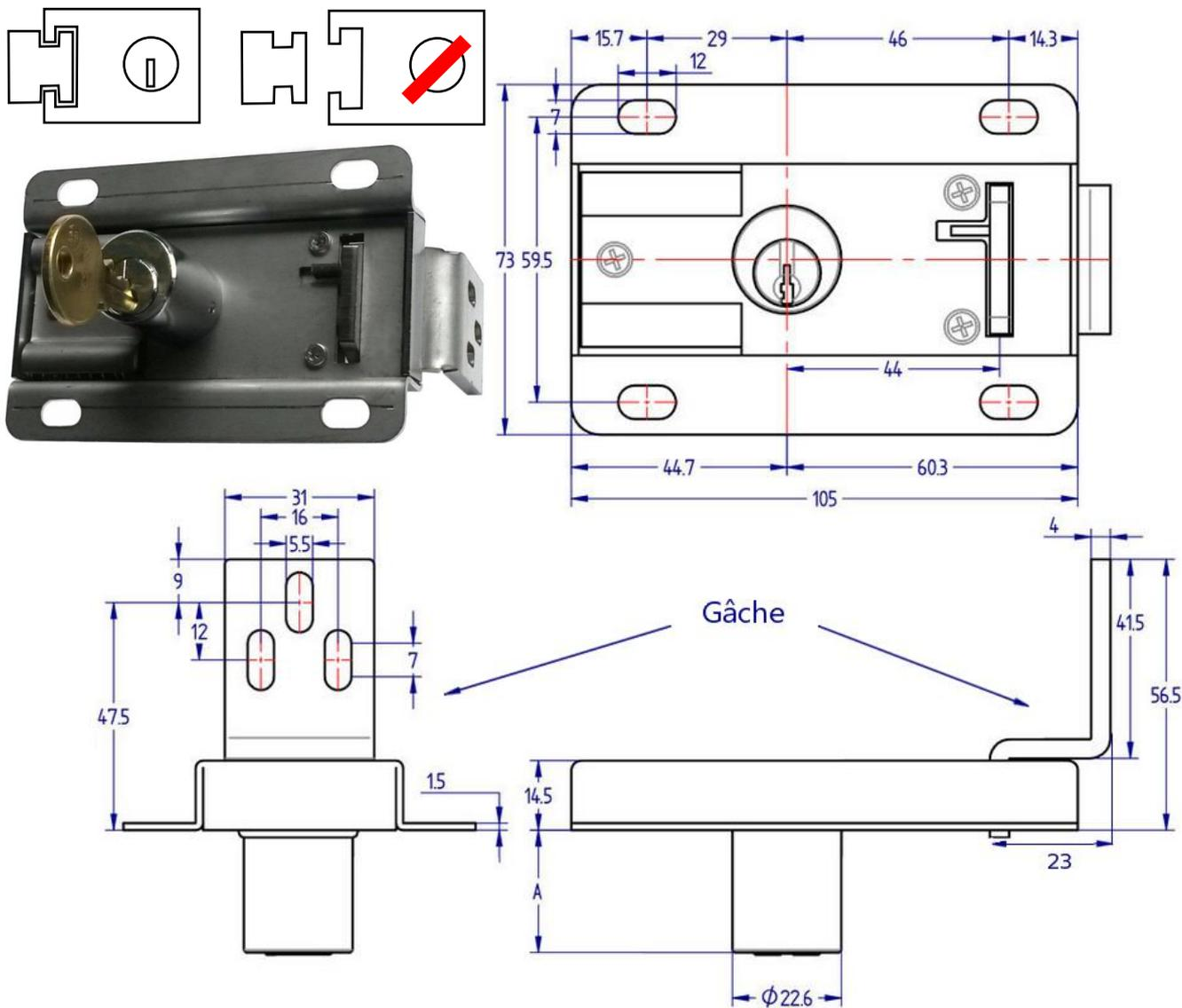
Verrou et gâche en inox AISI 304 - Cylindre laiton chromé avec goupilles et ressorts en inox AISI 303.
